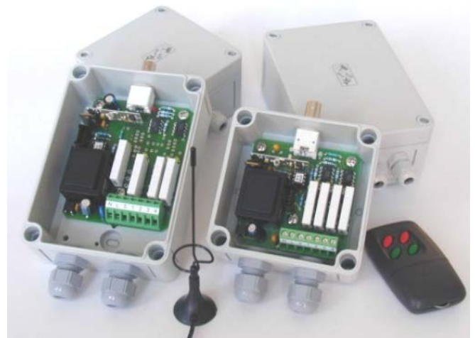
Funkfernsteuer-Empfänger EFB-EK4-PS130 (li.) und PS940 (re.)
